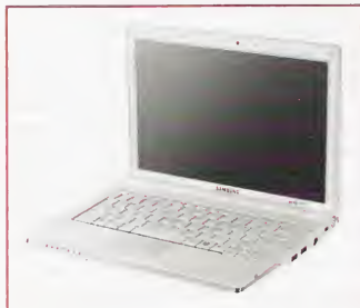
Габариты нетбуков не позволяют разместить в их корпусе оптический привод
